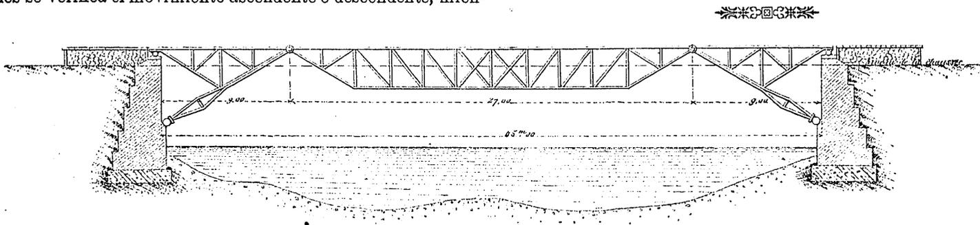
tras que las cabezas superiores se apoyan en el estribo por medio de rodillos de dilatación.
