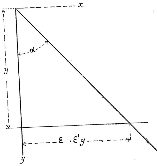
(figura 15) el perfil de la presa con una inclinación en el paramento de aguas abajo, definida por el ángulo  $\alpha$  en el vértice, cuya tangente será  $\epsilon'$ .
