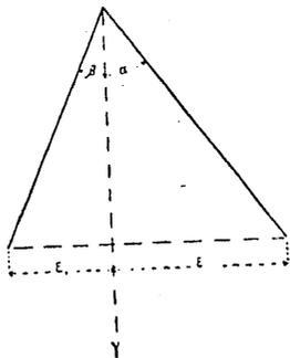
Sea el representado por la figura 18 un perfil triangular en que la inclinación de los dos paramentos está definida por la magnitud de los ángulos  $\alpha$  y  $\beta$ , que forman respectivamente con la vertical, siendo
