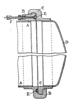
lidad de esta última se asegura, finalmente, por medio de un tubo de plomo anular cerrado E, alojado en una ranura de B, y en el cual se inyecta, por la válvula F, aceite á gran presión.
