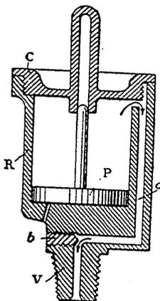
Este engrasador, que se atornilla por *V* al órgano que se quiere lubricar, se compone de un depósito *R* lleno de aceite ó de grasa consistente, de una tapadera atornillada *C* y de un émbolo *P*. La acción de la fuerza centrífuga sobre el émbolo tiende á aplicarle sobre la tapadera y éste impele el lubricante por el canal *c*. Un tapón de tornillo *b*, terminado por un puntero, regula la velocidad de salida.
