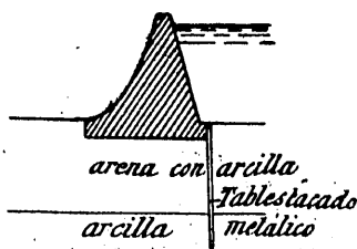
Fig. 9. a Presa de fábrica con cortina protectora.
