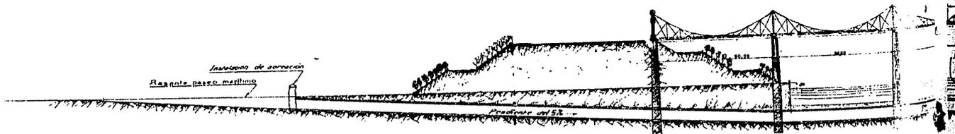
Fig. 9. Corte longitudinal del puente para el Paseo Marítimo
