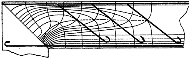
Fig. 1. Isostáticas en el extremo de un dintel
