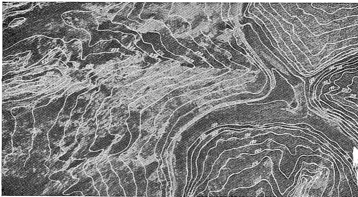
Fig. 2-3. — Aerofotogrametría : Superficie volada con curvado sobrepuesto, gracias a la red de apoyo. El estudio de nuestros problemas puede hacerse, de entrada, con tan eficaz auxiliar.
