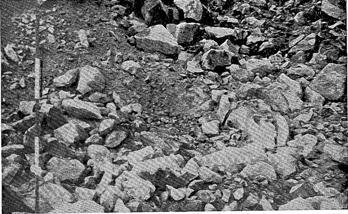
Fotografía 2.— Aspecto del material obtenido por voladura. La gradación de tamaños es buena para la formación de pedraplén.
