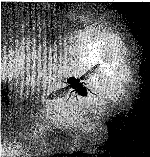
Fig. 8. — Fotografía de la imagen virtual formada por la reconstrucción de un holograma, obtenida con la misma técnica de la figura anterior. Las bandas verticales son parte de la onda de compresión producida por el aleteo de la mosca.
