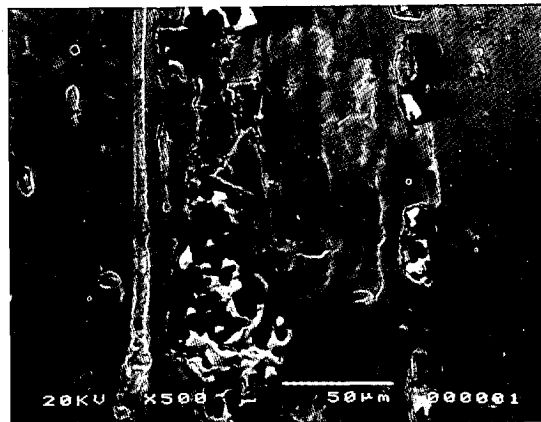
Foto 1. Detalle de escorias en hierro pudelado.
