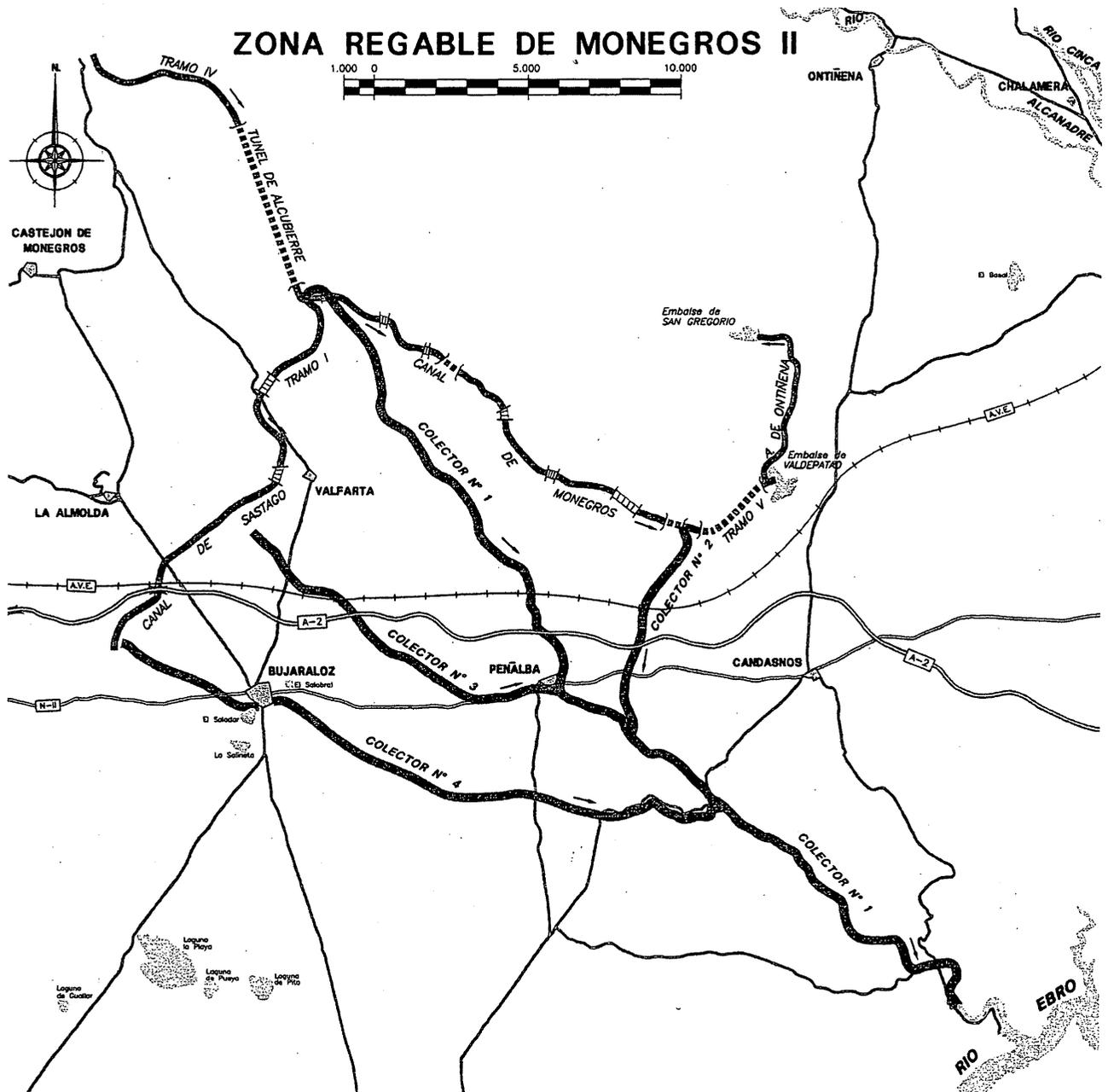
Anteriormente, el agua de escorrentía desaguaba por el centro de los barrancos excavados en la cota más baja de dichos valles. El trazado de los colectores coincide básicamente con los antiguos barrancos, pero se han hecho las modificaciones convenientes para adaptarlos a una sucesión de curvas y rectas, así como para minimizar las afecciones.
