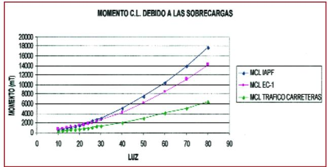
Fig. 1. Esfuerzos de flexión en el centro de una viga isostática generados, para distintas luces, por las sobrecargas nominales de tráfico ferroviario definidas de la IAPF, Eurocódigo y la instrucción española para puentes de carretera.
