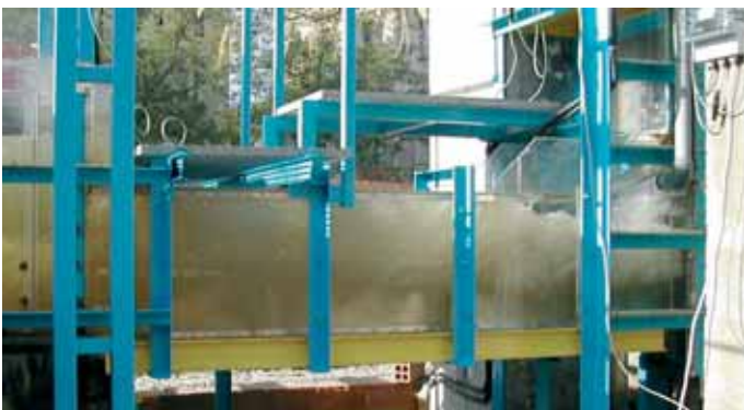
Vista general del modelo. A la derecha se aprecia el depósito cabecera (embalse), y a la izquierda el depósito de desagüe (río) y en la parte central el conducto
