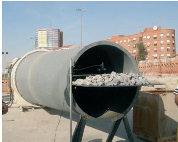
Fig.2. Prueba elemental del vuelo del balasto.
