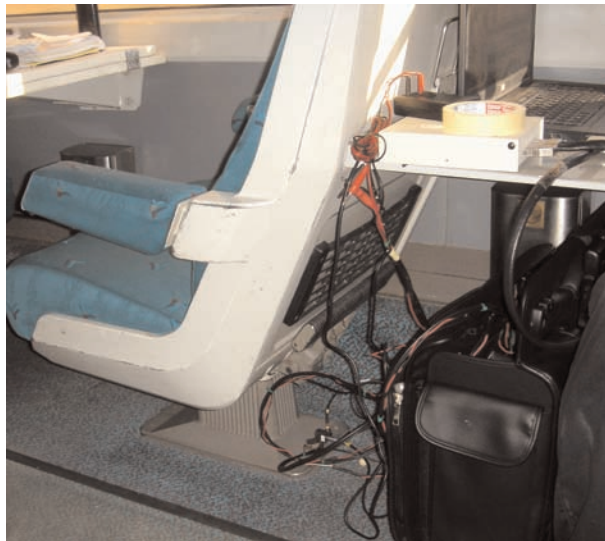
Fig 8. Medida de aceleraciones y velocidad a bordo del tren con acelerómetros y GPS (foto MMM).
