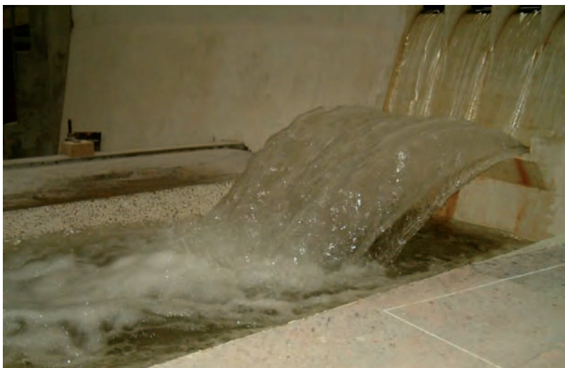
Fig. 10. Modelo reducido vertiendo la Avenida de Proyecto.
