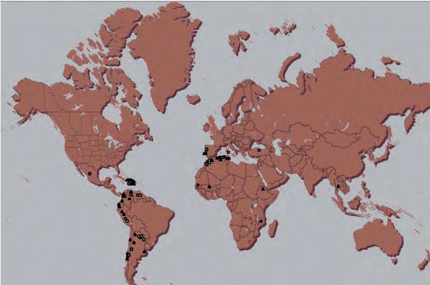
● PRESA DE RCC ● PRESA DE GRAVEDAD ▲ PRESA DE TIERRAS ▲ PRESA DE ESCOLLERA ▲ PANTALLA DE HORMIGÓN ▲ PANTALLA ASFÁLTICA ■ PRESA ARCO/BÓVEDA
