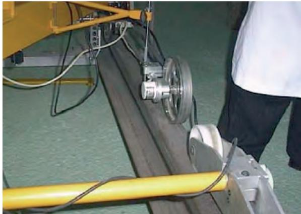
Fig.9. Detalles del carrito manual de medida de geometría de vía.
