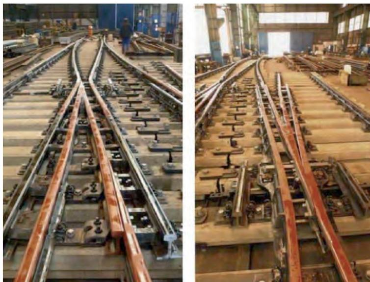
Fig. 22. Premontaje en taller de diagonal de corazón de punta móvil.
