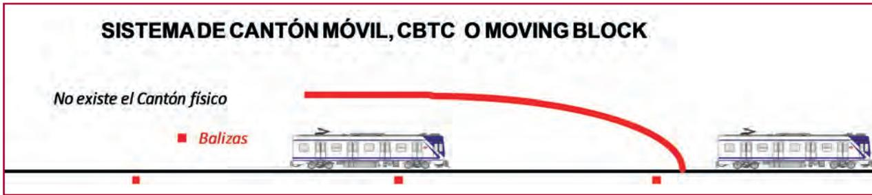
Fig. 3. ATP con Cantón móvil.
