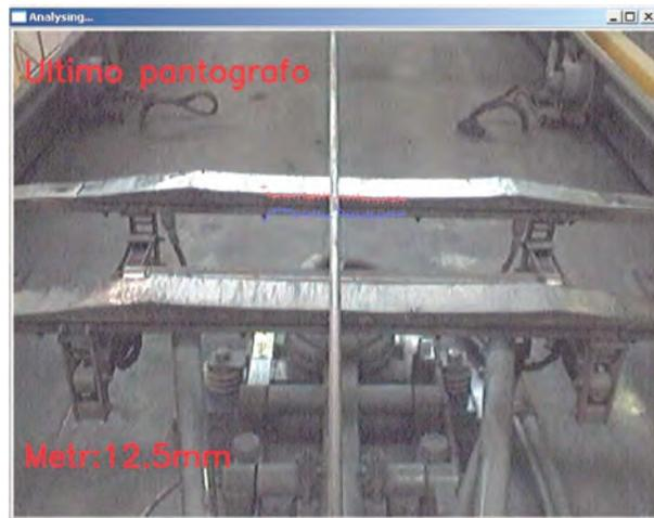
Fig. 18. Estudio de desgaste de pletinas de pantógrafo en Metro de Madrid.
