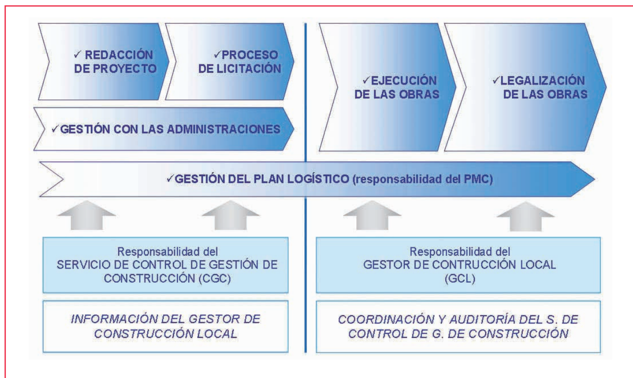
Fig. 5. Distribución de responsabilidades entre el Servicio de Control de Gestión de Construcción (Project Management de Cabecera) y los Gestores de Construcción Local.
