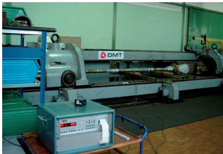
Foto 24: Ensayo de tesado antes y después de rotura de cable cerrado de 10.100 kN (teórico).
