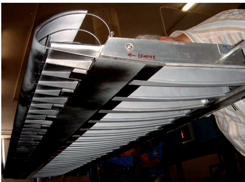
Foto 9: Vistas de los túneles de viento realizados: Fotos primera y segunda del modelo aeroelástico completo; foto tercera del modelo seccional.
