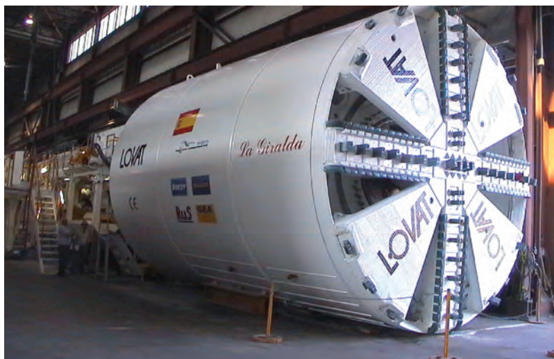
Figura 4 – Escudo EPB LOVAT Øexc 6,500 mm construcción del túnel nº 1/EPB LOVAT Shield Øexc 6,500 mm.
