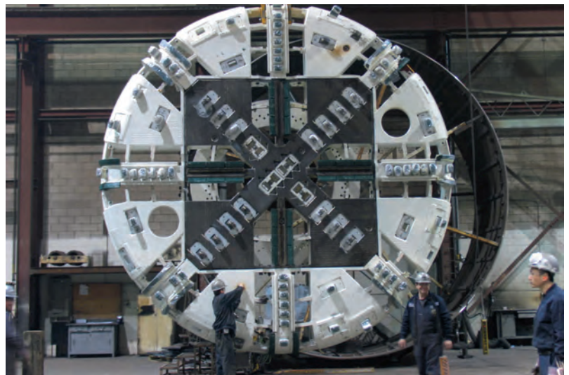
Fig. 6. Vista general de la nueva rueda de corte/ General view of the new rotary cutter.
