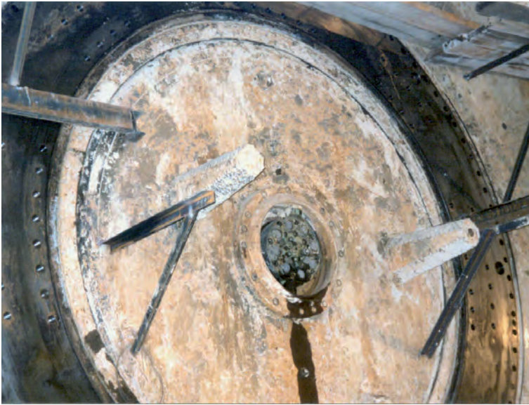
Fig. 2. Barras batidoras en cámara.
