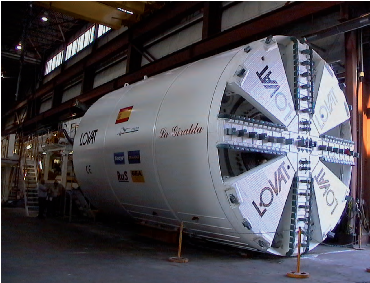
Fig. 7. Escudo EPB Lovat Ø 6.100mm Construcción del túnel 1.
