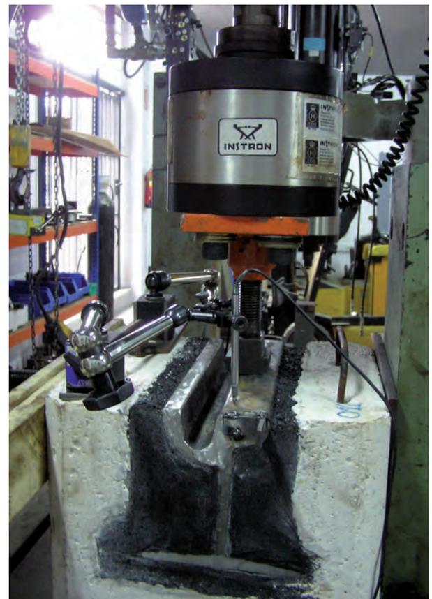
Fig. 8. Vista general de la disposición del prototipo en el ensayo de carga vertical estática.
