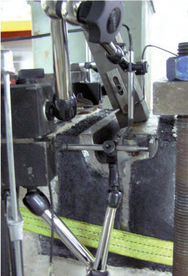
Fig. 9. Vista general del prototipo en el ensayo de carga estática angular (22°).
