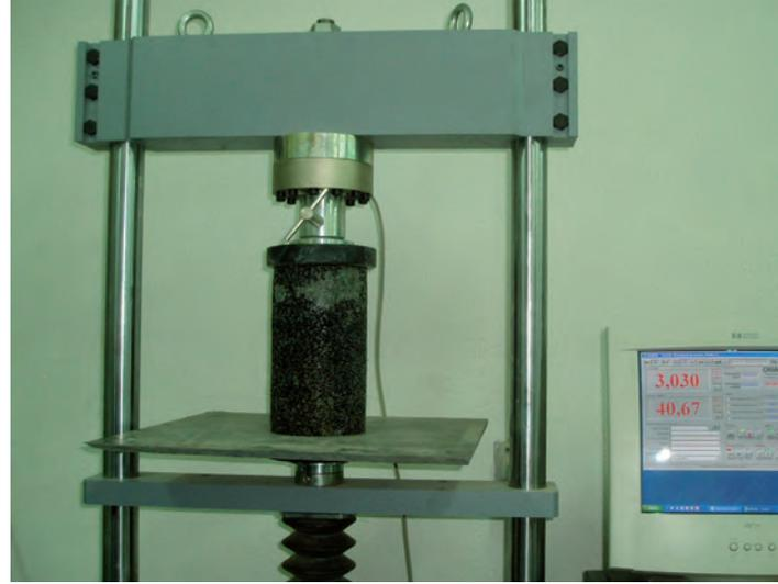
Figs. 4 y 5. Ejemplo de probetas y ensayo a compresión simple.
