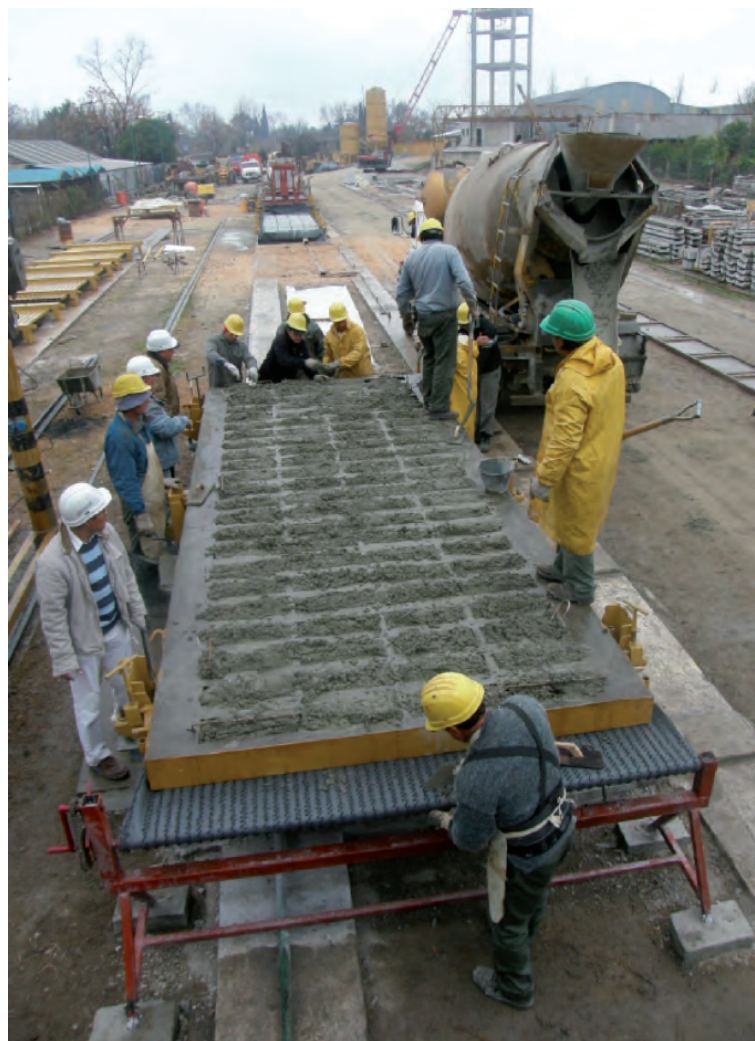
Fig. 18. Fabricación de geomantas en una planta de prefabricados. El polipropileno de base sobresale 50 cm para solaparse con el de las mantas contiguas.
