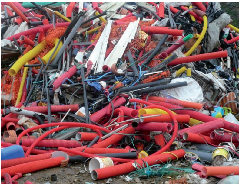
Fig. 3 Plásticos diversos separados de RCD/ Fig. 3. Diverse plastics separated from CDD.
