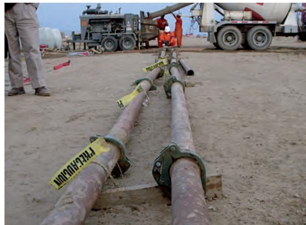
Foto 4. Tuberías de acero utilizadas en el ensayo.
