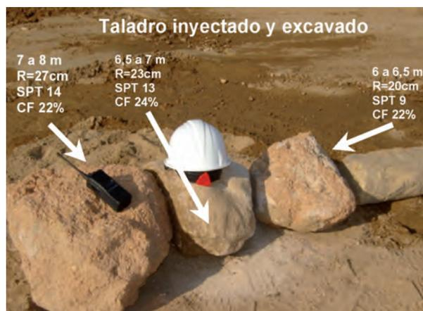
Foto 7. Bulbos de mortero obtenido en el taladro excavado.
