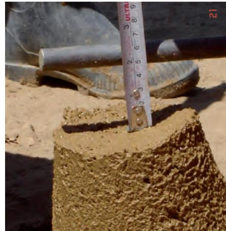
Foto 2. Prueba de control del mortero (cono de Abrams de 4.5 cm).
