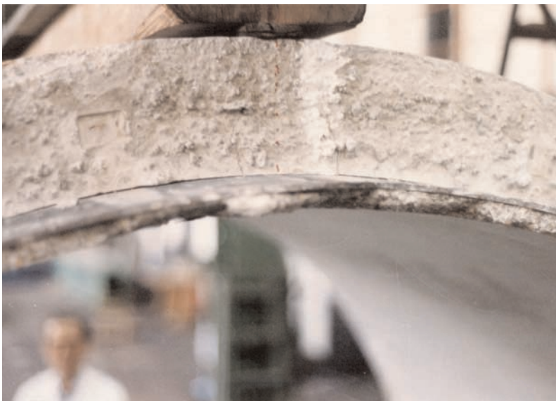
Foto N° 7. Tubo con una carga de 15,5 tn/m/Picture 7. Tube with a load of 15.5 t/m.
