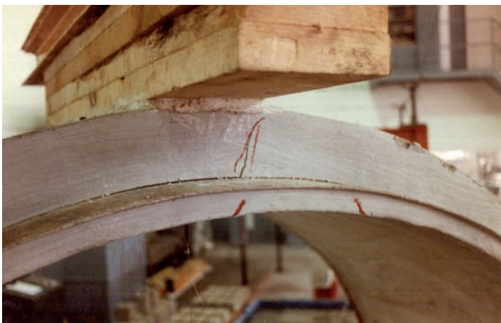
Foto N° 2. Empieza a separarse el hormigón exterior de la chapa / Picture 2. The outer concrete layer begins to detach itself from the steel plate.
