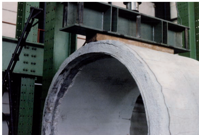
Foto Nº 9. Rotura del tubo/Picture 9. Tube at breaking point.
