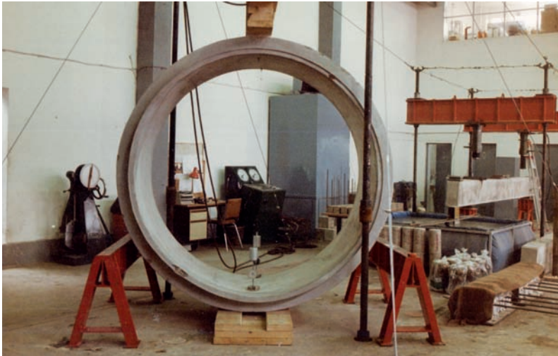
Foto N° 1. Tubo de Ø2000 preparado para el ensayo / Picture 1. Ø2000 tube prepared for the test.
