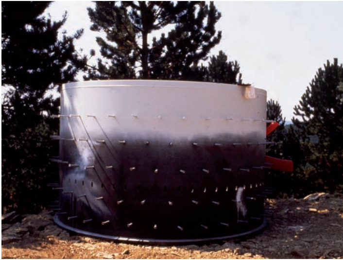
Foto Nº 10. Virola con conectores utilizado en 1996/Picture 10. Embedded steel section with connectors used in 1996.
