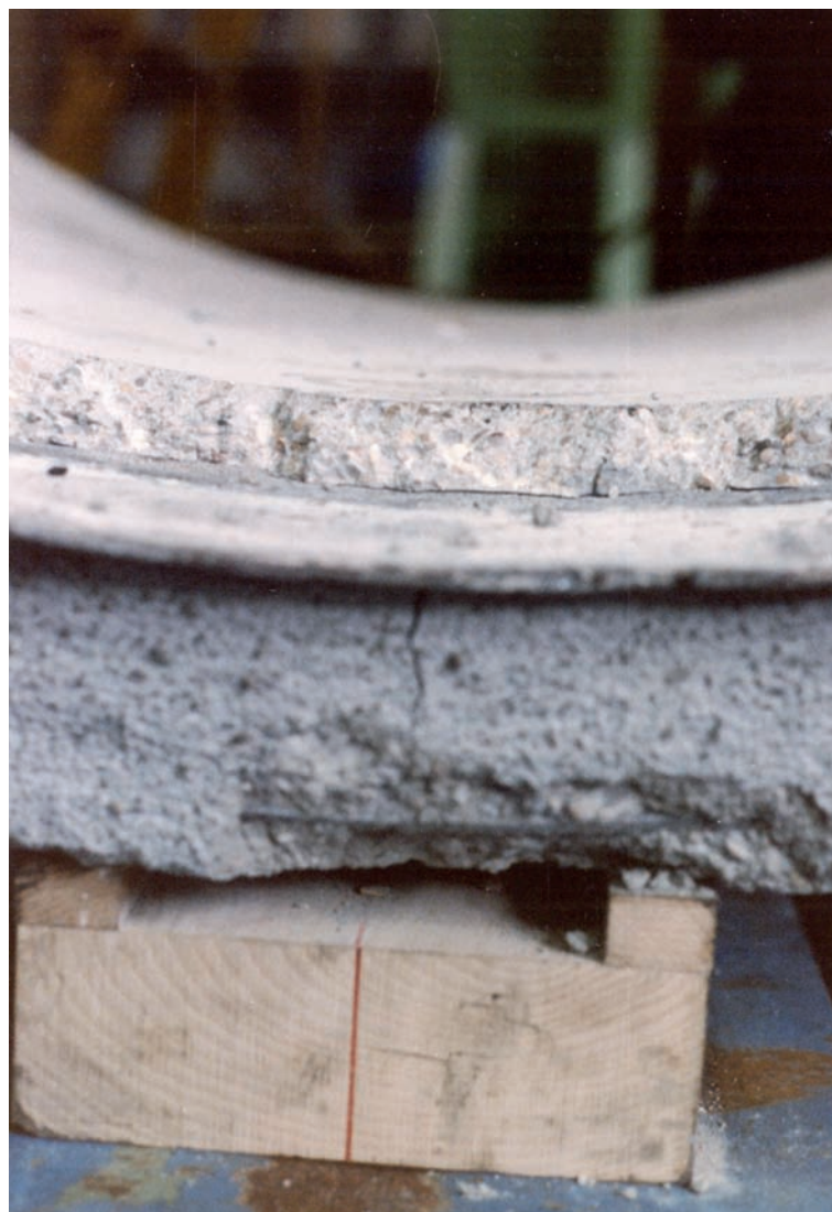
Foto Nº 8. Tubo con carga de 16,8 tn/m/Picture 8. Tube with a load of 16.8 t/m.
