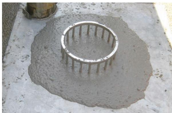
Fig. 10. Ensayo anillo japonés.
