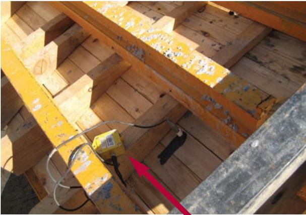
Fig. 20. Termopolar colocado en la parte de arriba.
