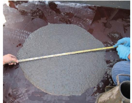
Fig. 18. Ensayo escurrimiento: 68,5 cm de diámetro máximo.
