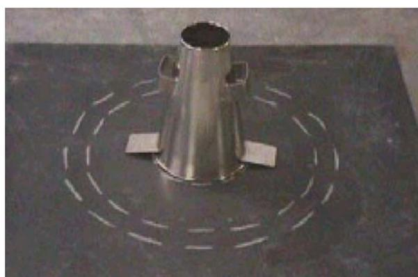
Fig. 9. Ensayo de escurrimiento.
