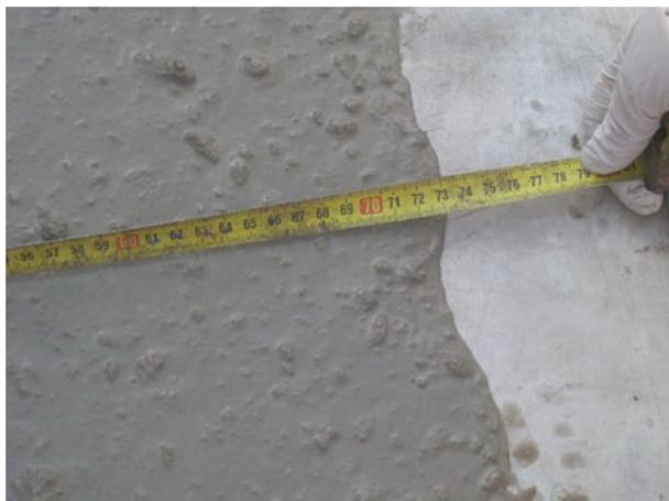
Fig. 11. Perímetro de la "torta" sin exudación.
