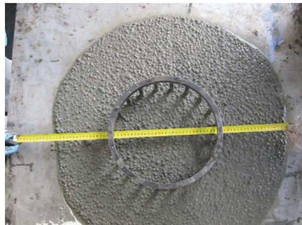
Fig. 12. Ensayo de escurrimiento. HAC ligero.
