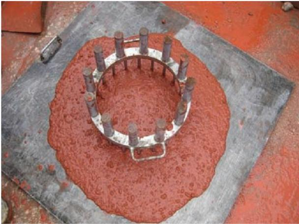
Fig. 13. Ensayo del anillo japonés. HAC con fibras. HAC coloreado con pigmento rojo.
