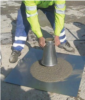
Fig. 16. Ensayo de escurrimiento en planta.
