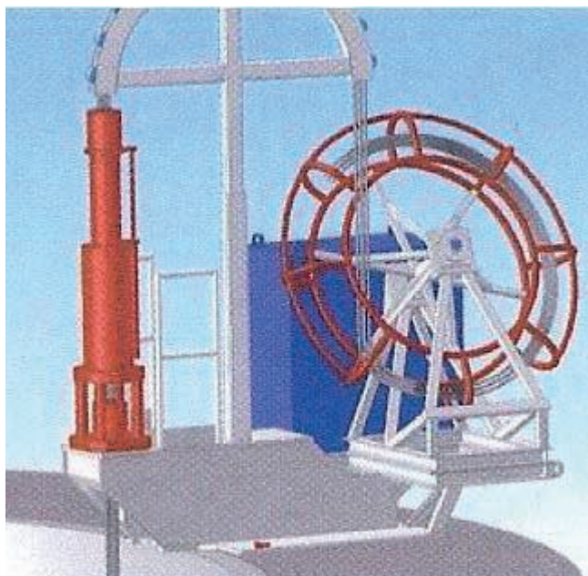
Fig. 7. Esquema y vista de un gato de retención del revestimiento/ Diagram and view of a release jack of the lining.
