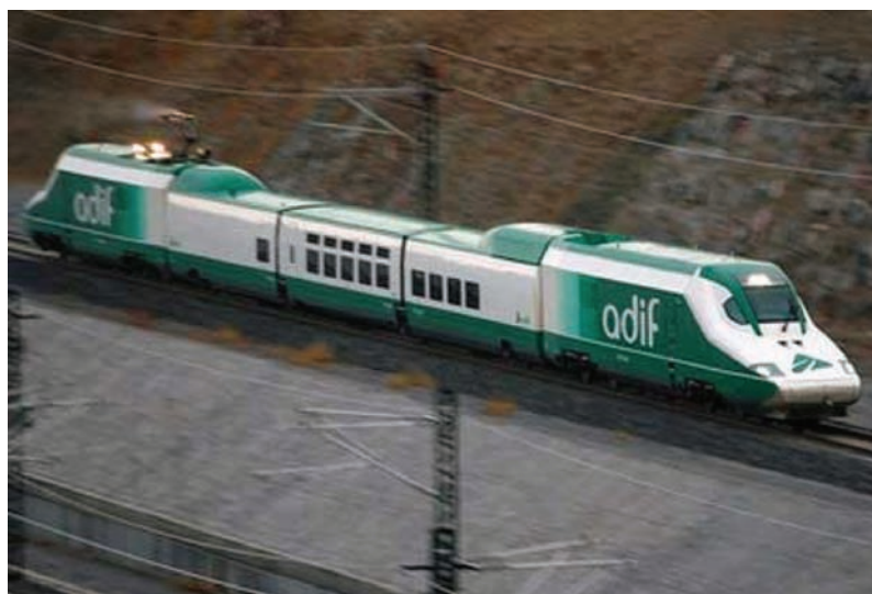
Foto 2. Tren Séneca realizado una auscultación a alta velocidad.
