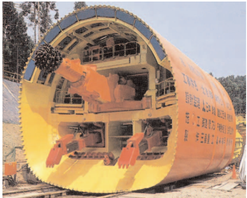
Fig. 2. Escudo con brazos de tipo rozador y retroexcavador / Roadheader / Retro boom type Shield.
