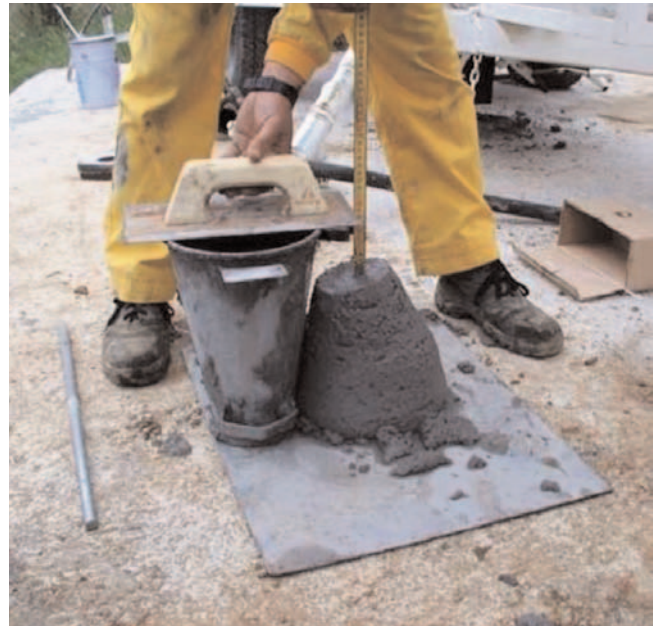
Fig. 21. Control de asiento en Cono de Abrams del mortero a utilizar en inyecciones de compactación (Henríquez y otros, 2009).
