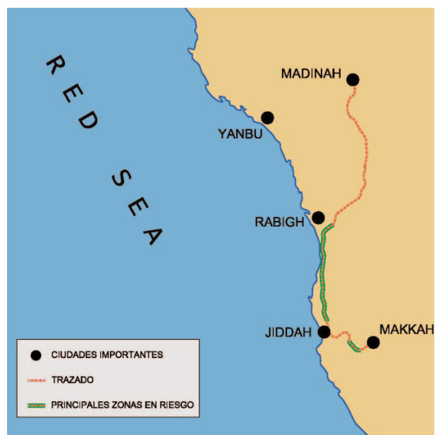
Fig. 2. Mapa del trazado del ferrocarril Haramain en el que se han destacado las zonas susceptibles de ser afectadas por arenas eólicas/Map of the Haramain railway alignment. Areas likely to be affected by aeolian
