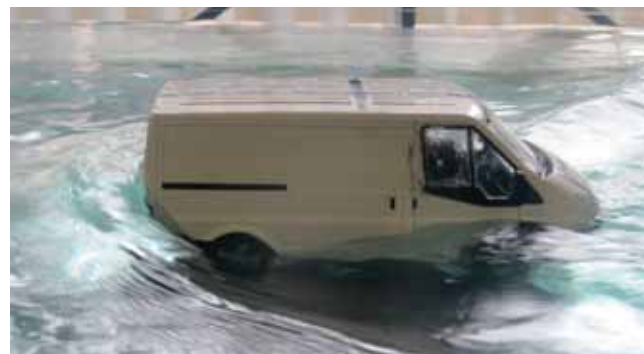
Fig. 8a. Diferentes ángulos de orientación de vehículos realizados en los experimentos / Different vehicle orientation angles undertaken in the experiments Fig. 8b. Modelos de vehículos parcialmente sumergidos en canal / Partially submerged model vehicles in flume
