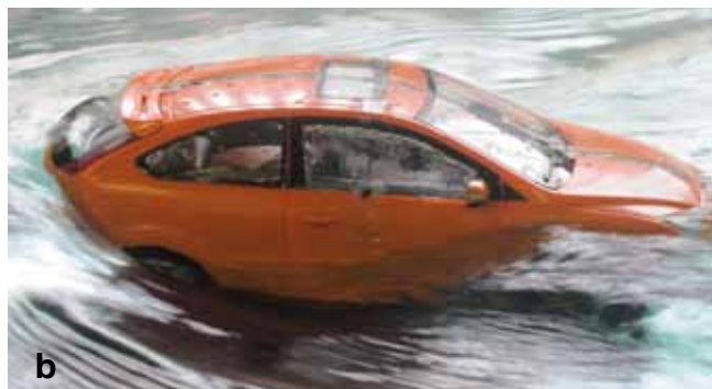
Fig. 8a. Diferentes ángulos de orientación de vehículos realizados en los experimentos / Different vehicle orientation angles undertaken in the experiments Fig. 8b. Modelos de vehículos parcialmente sumergidos en canal / Partially submerged model vehicles in flume
