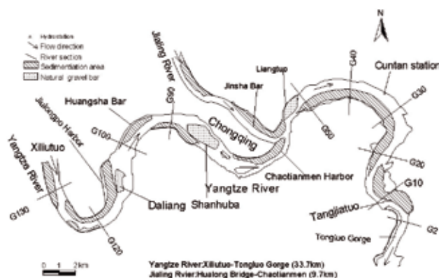
Fig. 10 La sedimentación en la zona de Chongqing después de 80 años de funcionamiento del embalse de las Tres Gargantas (resultados de los modelos experimentales físicos). Las áreas sombreadas indican los lugares donde se produciría la sedimentación acumulada. G2 - G130 representan las secciones transversales medidas (según Wang et al, 1990)
