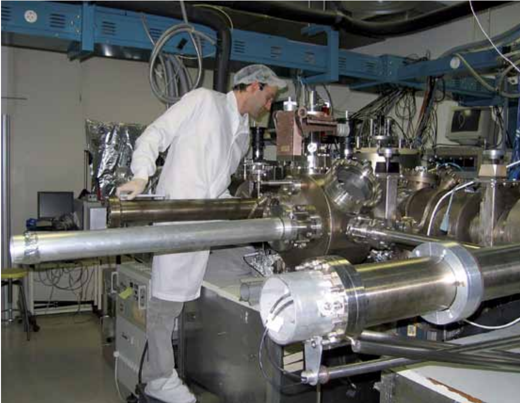
Fig. 3. Reactor MBE del IMM-CSIC
