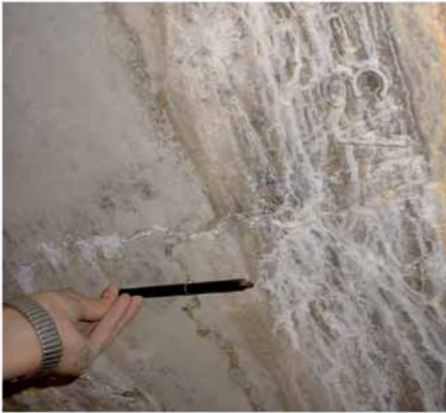
Fig. 5. Registro de la fisuración producida a lo largo de las diferentes etapas de carga aplicadas/Recording of cracking produced over the different loading stages
