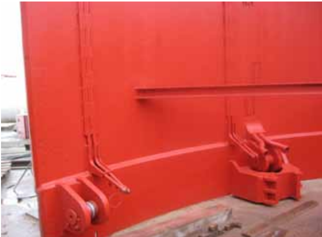
Fig. 3. Escudo de cola preparado para colocar las líneas de inyección
