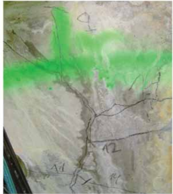
Fig. 5. Registro de la fisuración producida a lo largo de las diferentes etapas de carga aplicadas/Recording of cracking produced over the different loading stages
