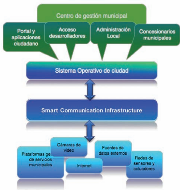
Esquema de la Infraestructura de Comunicación Inteligente
