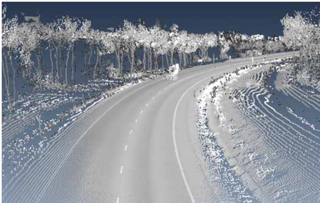
Fig. 3. Proyecto Rehabcar. Nube de puntos 3D proporcionada por el equipo topográfico de escaneado láser desarrollado
