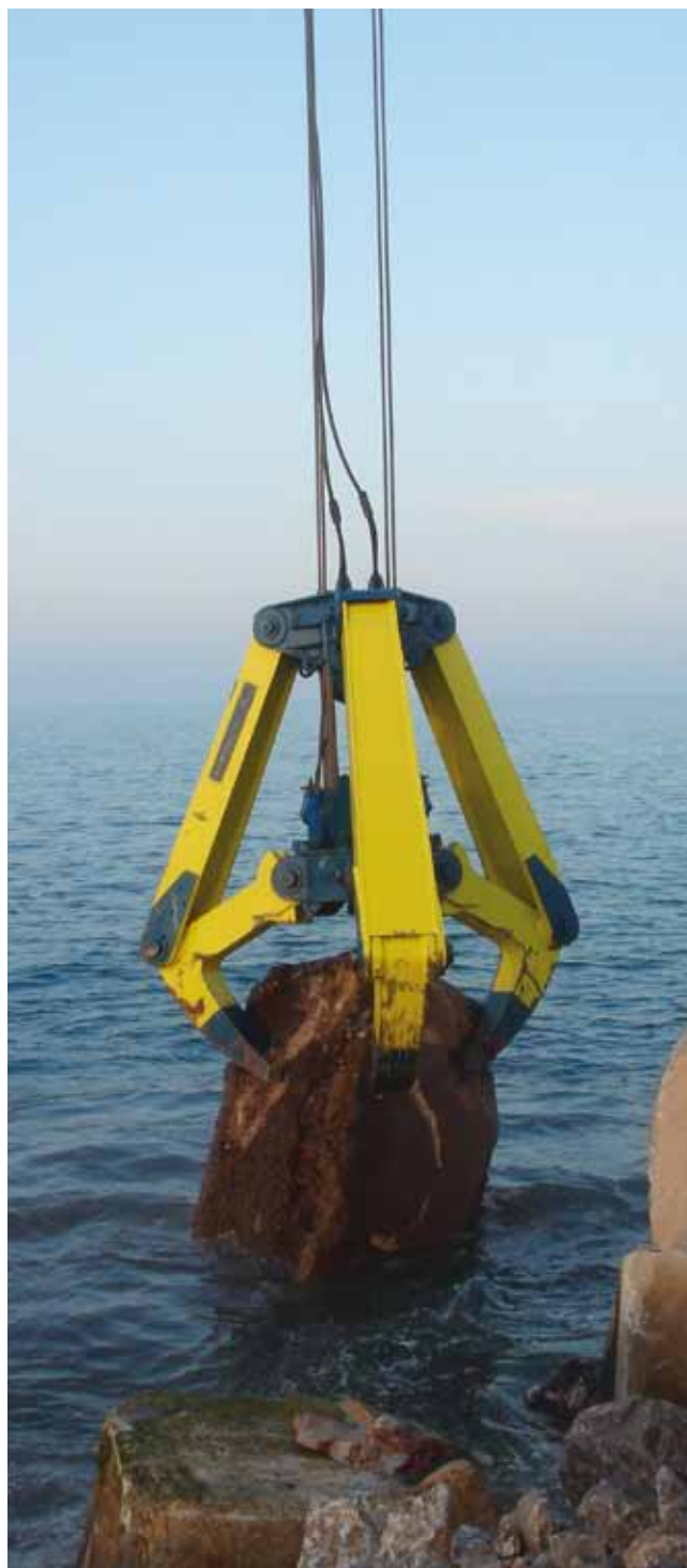
Pinza SATO Grab en uso, extrayendo bloques en el Puerto de Gijón. Su cálculo y dimensionamiento de detalle con elementos finitos fue realizado en colaboración con un equipo de la UPM
