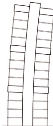
Fig. 11. Deformación del núcleo central con vigas transversales
