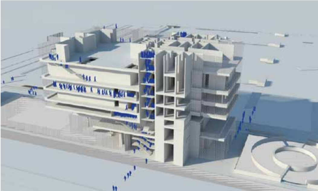
Fig. 2. Modelado de evacuación de un edificio alto
