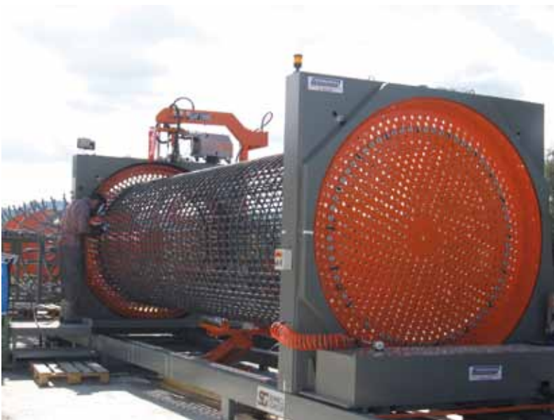
Figs. 7a y 7b. Prefabricación y montaje de tramos de ferralla en pilotes
