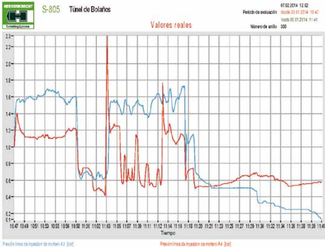
Fig. 6. Muestra de la información facilitada por el sistema en tiempo real relativa al anillo 300
