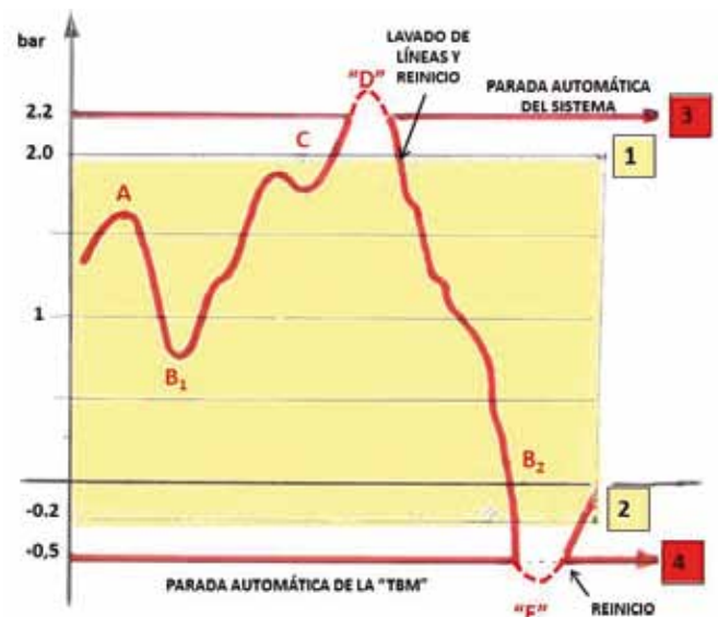
Figura 9. Esquema de las presiones de trabajo programadas
