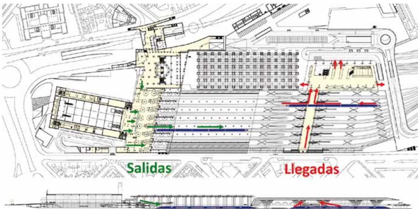
Fig. 1. Nuevo Complejo Ferroviario de la Estación de Atocha. El esquema funcional de doble terminal: salidas y llegadas, permite duplicar la capacidad de los andenes término de Puerta de Atocha
