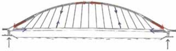
Fig. 2. Puentes arco con tablero inferior
