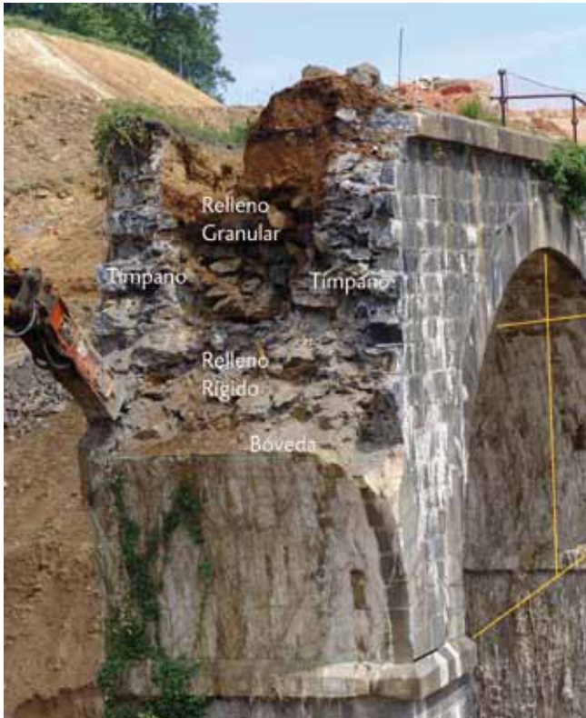
Fig. 8. Autopsia del puente de Urnieta tras su ensayo hasta rotura
