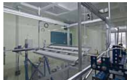
Túnel de viento para estudios de aeroelasticidad de puentes (CITEEC)
