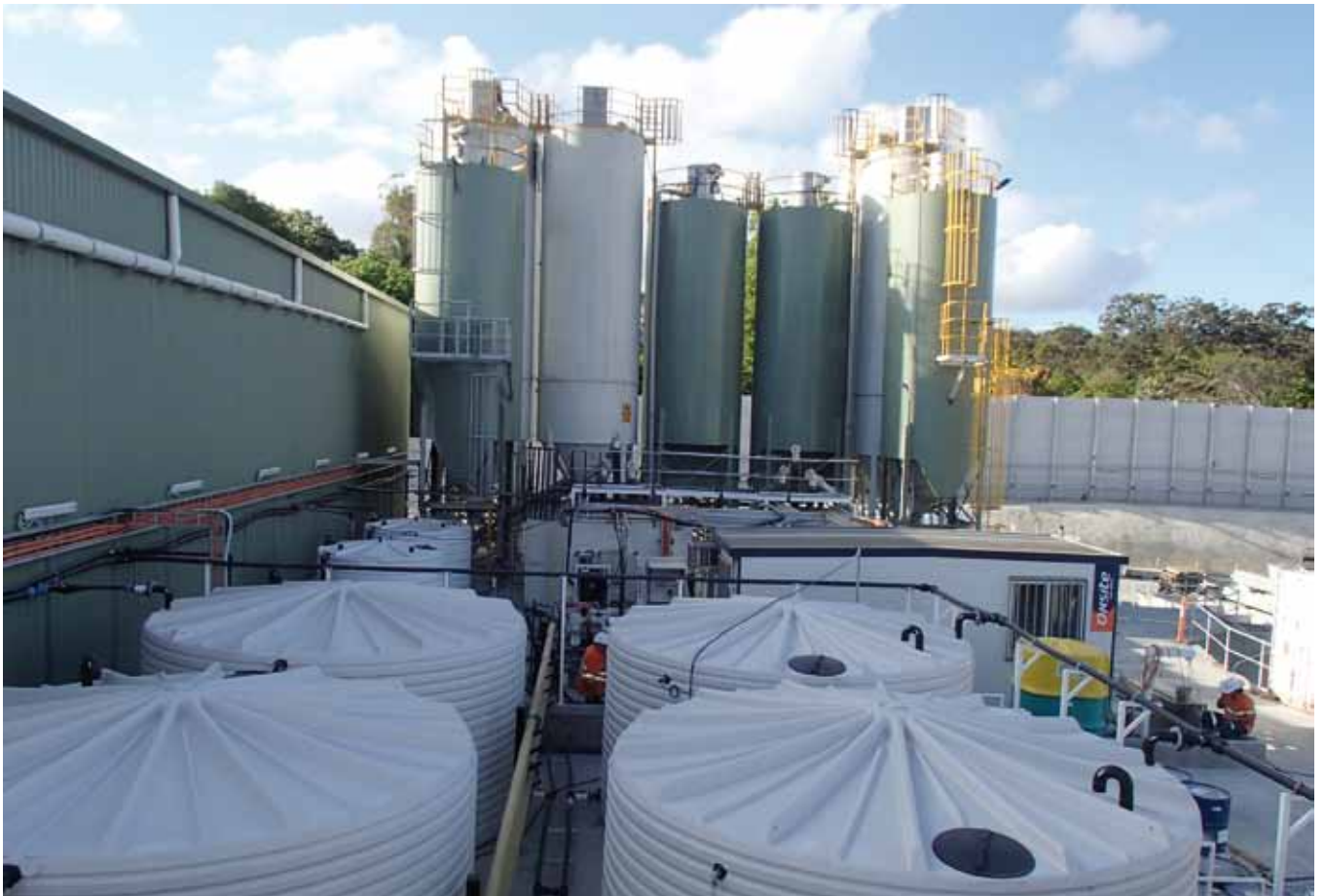
Planta de elaboración del mortero bicomponente
